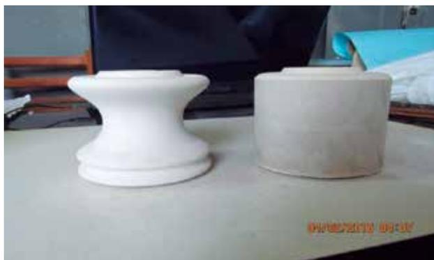
**Figura 2.** Fotografía del precursor del aislador tipo ANSI 53-2 después (izquierda) y antes (derecha) de tornear.
