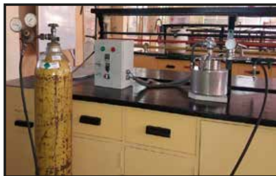
Figura 3. Reactor batch para la hidrogenación de palmitato de metilo.
