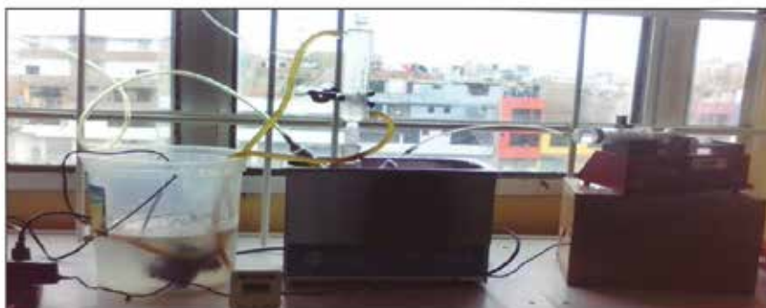
Figura 2. Sistema de obtención del nanocompuesto polimérico (polimerización in situ ).
