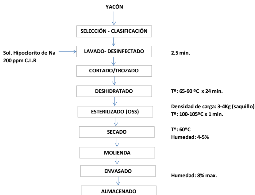
Figura 1. Flujo de operaciones del proceso de descontaminación microbiana del yacón por el sistema de esterilización orgánica (Tratamiento OSS).
