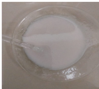
Figura 2. Nanocomposito de polisiloxano funcionalizado con NPs-Ag.
