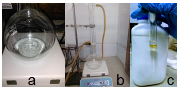
Figura 1. Secuencia de síntesis del polisiloxano a) Éter con diclorodimetilsiloxano b) Equipo de reacción a reflujo c) Polisiloxano.
