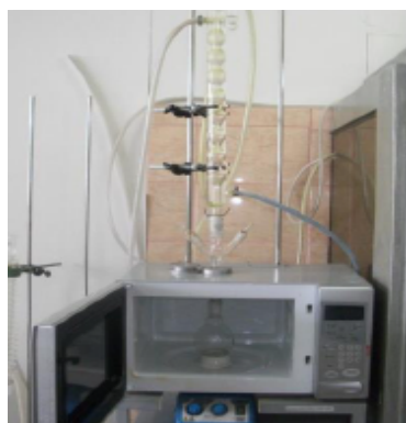
Figura 2. Microondas adaptado para síntesis química.
