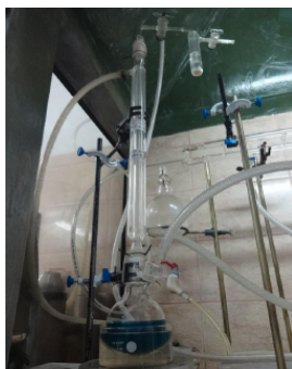
Figura 1. Imágenes del sistema Schlenk para la preparación de Cu(Ac) 2 .
