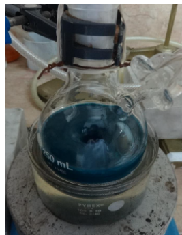
Figura 1. Imágenes del sistema Schlenk para la preparación de Cu(Ac) 2 .
