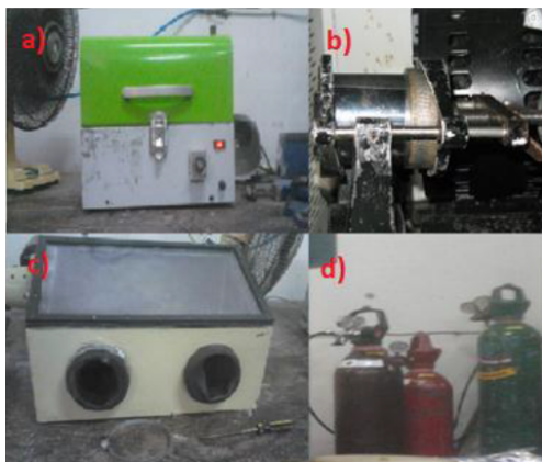
Figura 2. a) Molino de sistema vibratorio modelo SPEX 8000M; b) Motor y brazo mecánico; c) cámara de guantes; d) Cilindros para gases inertes.
