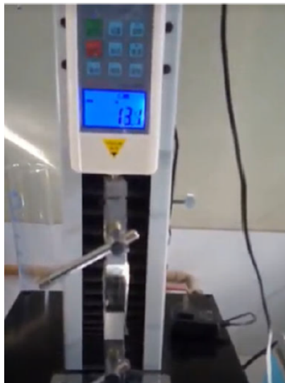
Figura 4. Texturómetro digital AEL 200 para evaluación de fuerza de tracción.
