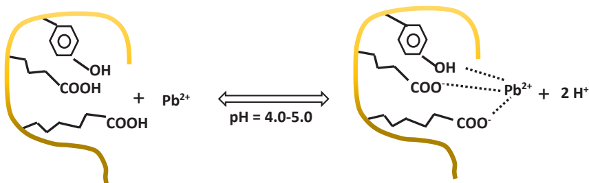
Figura 8. Mecanismo de biosorción de iones de Pb (II), con MRLZ.
