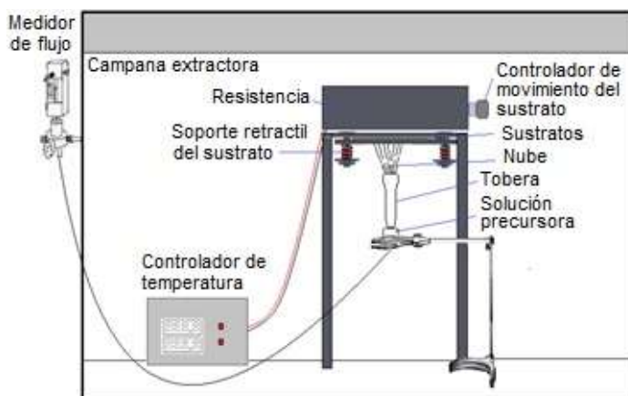
Figura 2. Esquema del equipo de rociado pirolítico.
